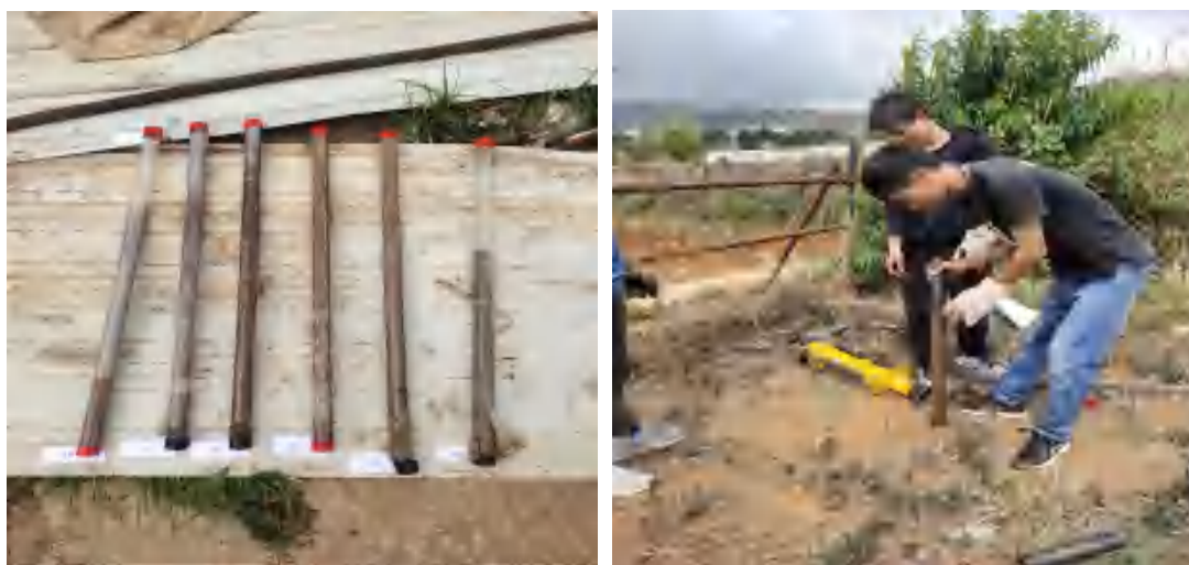
图 5.2-2b HPP13 液压土壤取样钻机土壤现场采样图
